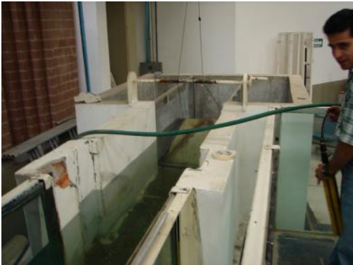
Figura 1.3 Compuerta del canal
