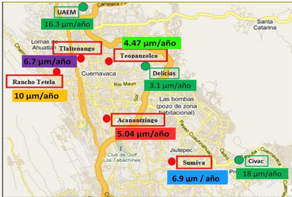
Figura 5. Mapa de Cuernavaca con la velocidad de corrosión obtenida durante este estudio y con tres sitios donde se realizaron estudios previos ( UAEM, Delicias y Civac).
