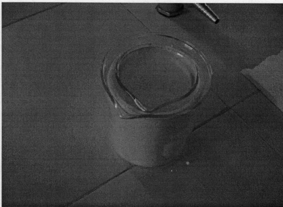
Figura 1. Calorímetro utilizado durante los experimentos, compuesto por dos vasos de precipitado aislados entre sí por una capa de unicel .
